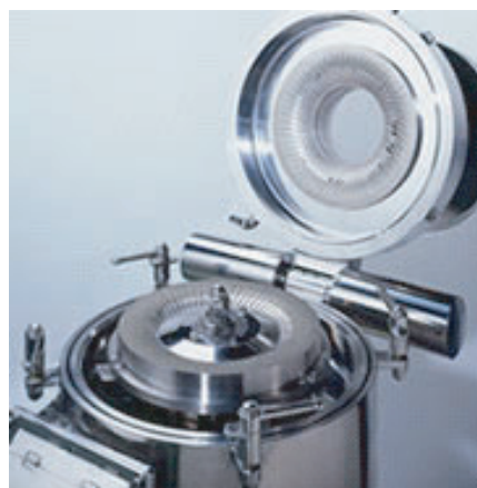
图4 研磨粉碎机的研磨室构造
