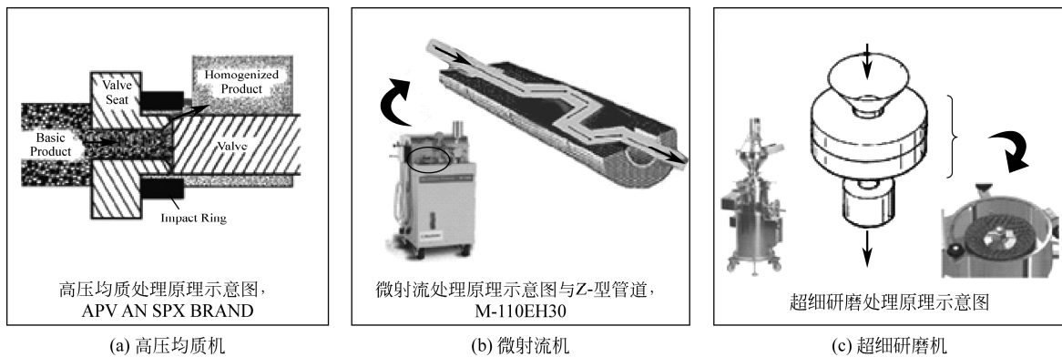
图 5 高压均质处理、微射流处理及超细研磨处理原理示意图 [45]
